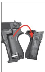
Снять накладку рукоятки.
