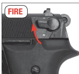
Для снятия оружия с предохранителя сместите рычаг вверх.
