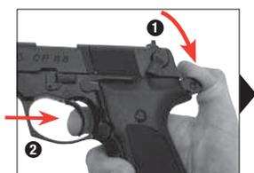
Поставить оружие на предохранитель. Выполните следующее, чтобы разрядить оружие:
