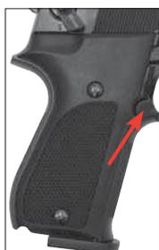
Поставить оружие на предохранитель. Нажать кнопку на накладке рукоятки.
