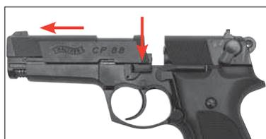
Нажать на рычаг предохранителя. Затвор открывается автоматически.
