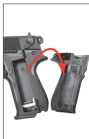
Снять накладку рукоятки.
