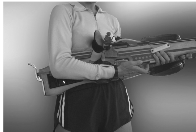
Рис. 9. Извлечение пустой обоймы из магазина (вид справа)
