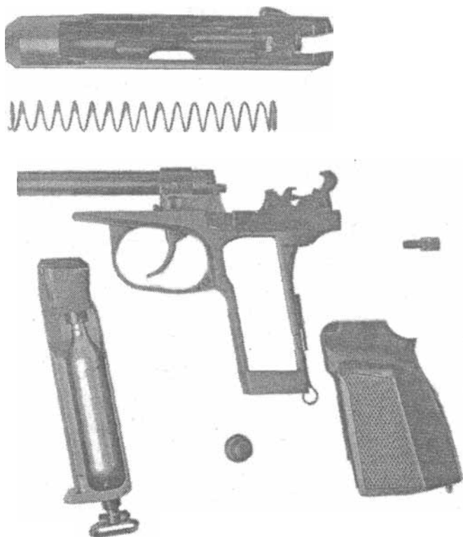
Неполная разборка пистолета МР-654К
