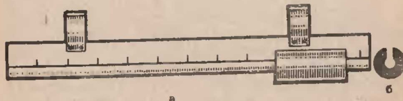
Рис. 2. Приспособление для изменения баланса оружия: а — штанга; б — подвижной грузик (вид спереди)
