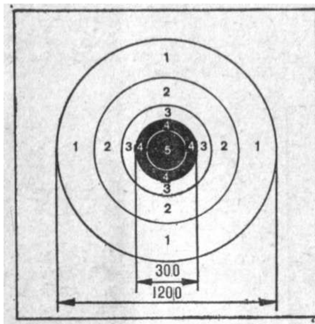
Рис. 18. Мишень № 4. Применялась для стрельбы на дистанцию 200 и 300 м из винтовки до 1940 г. Формат: 1400+1700. Диаметр: «пятерки» — 200; «четверки» — 300; «тройки» — 500; «двойки» — 800; «единицы» — 1200.
