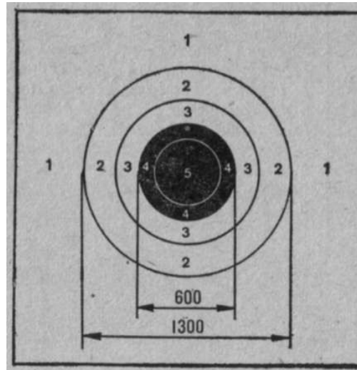
Рис. 21. Мишень № 2. Применялась для стрельбы на дистанции 400, 500 и 600 м из винтовки до 1949 г. Формат: 1800×1700. Диаметр: «пятерки» — 400; «четверки» — 600; «тройки» — 900; «двойки» — 1300; «единицы» — остальная площадь мишени
