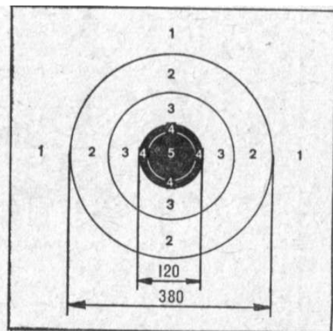
Рис. 14. Мишень № 7 А. Применялась для стрельбы на дистанцию 100 м из винтовки до 1930 г. Формат: 500×500. Диаметр: «пятерки» — 80; «четверки» — 120; «тройки» — 240; «двойки» — 380; «единицы» — остальная площадь мишени
