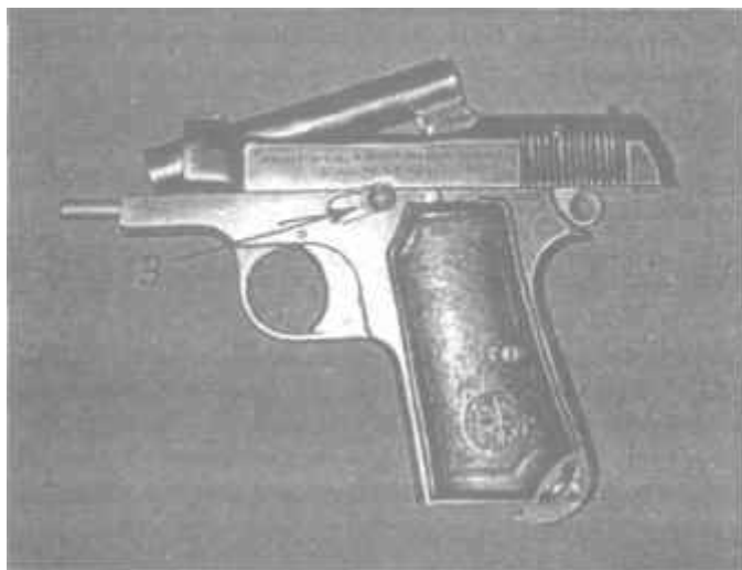
Фото 47. Для стопорения затвора предохранитель 3 повернут против часовой стрелки до упора. Ствол поднят назад, поднять вверх
