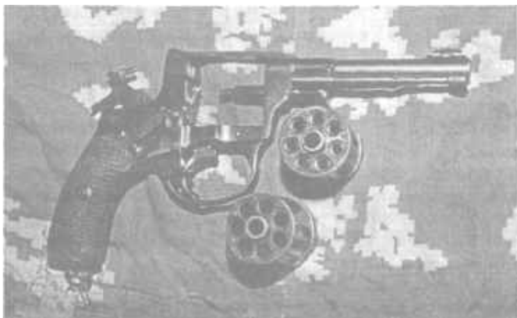
Фото 7. Малогабаритный наган при неполной разборке. Барабаны калибров 7,62 мм и 5,6 мм в сравнении
