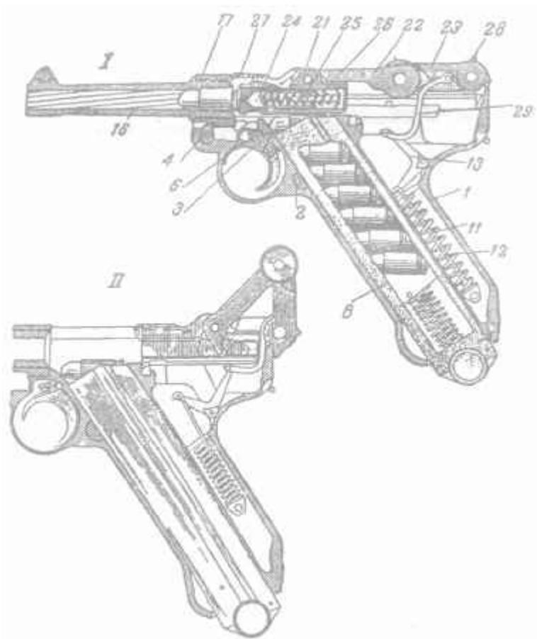
Схема 6. Разрез пистолета по оси:
